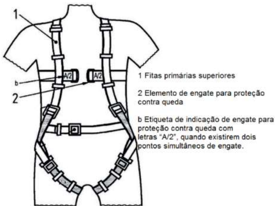
Figura 19. Dois pontos de engate simultâneos de retenção de quedas. Cada ponto é marcado com o símbolo A/2. O deve ser conectado simultaneamente aos dois pontos. Fonte: NBR 15836
